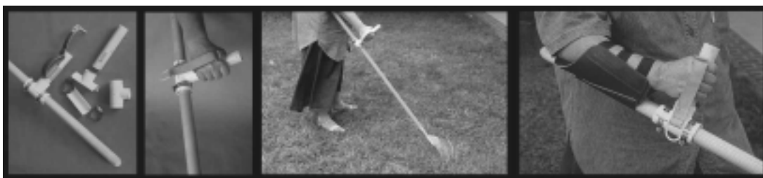
Figura 103: Adaptações em ferramentas de hastes longas a partir da utilização de tubos e conexões de PVC (GEOGHEGAN; WALSH, 2002).
