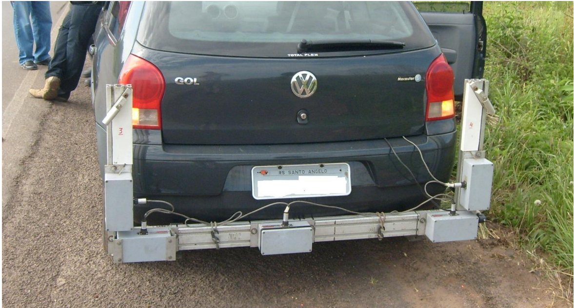
Figura 29: detalhe do perfilômetro inercial utilizado no levantamento da irregularidade nos segmentos estudados, com 2 módulos levantados.
