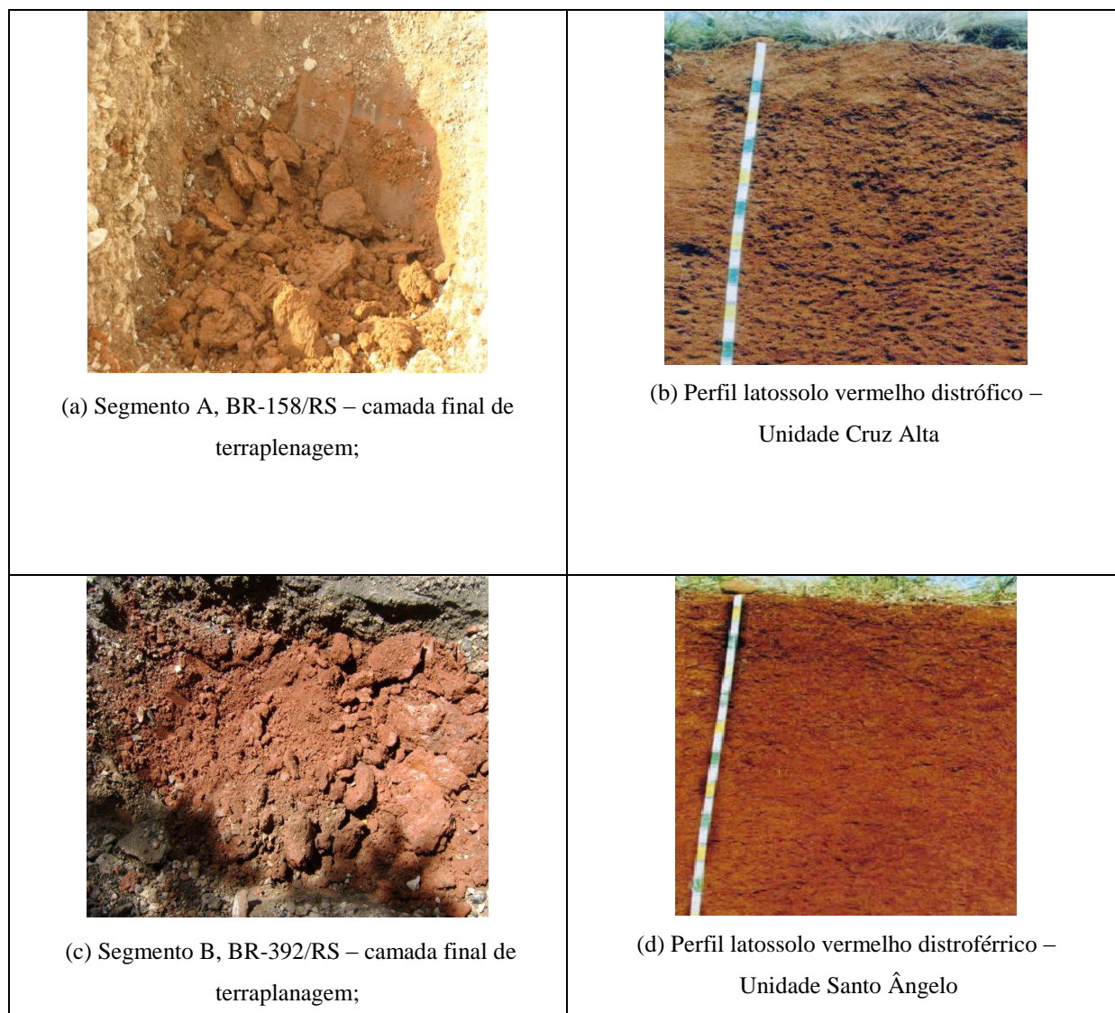
Figura 26: (a) e (c) sondagem no subleito dos trechos estudados; (b) latossolo vermelho distrófico (unidade Cruz Alta) e (d) latossolo vermelho distroférrico (unidade Santo Ângelo). (STRECK et al. , 2008)
