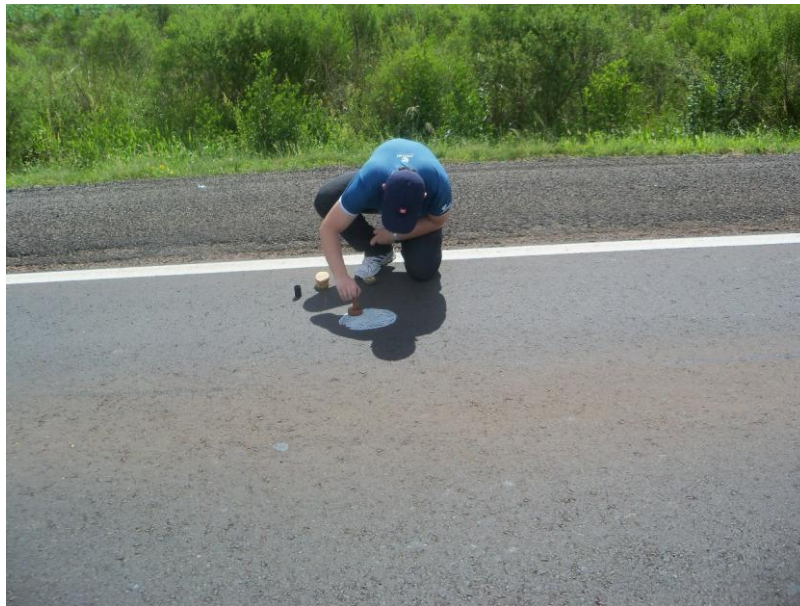
Figura 30: realização de ensaio de mancha de areia na BR-158/RS, km 206+220 LD.
