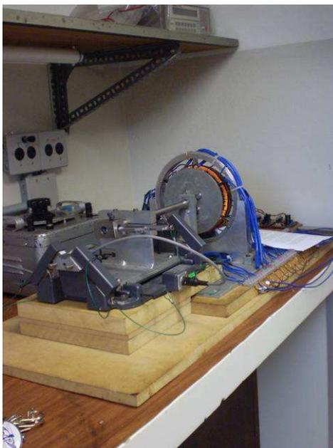
Figura 67. Esquema utilizado para medição do conjugado estático.
