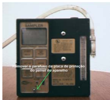
Bomba de Amostragem de Ar 37mm. “SKC Air Sampler Model de 224-PCXR-8”
