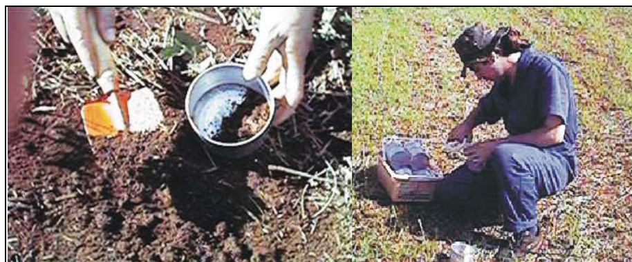
Figura 3.17: Retirada de amostra de solo para determinação do conteúdo de água no solo pelo método gravimétrico.
