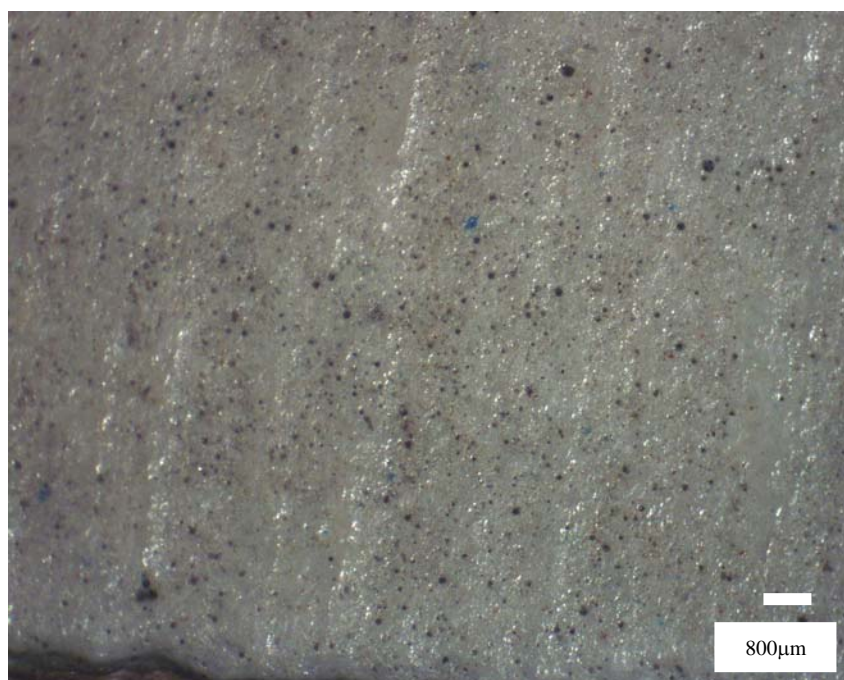
Figura 3.7: amostra de placa cerâmica após desgaste submetida à limpeza com ultra-som por 10min (40X)
