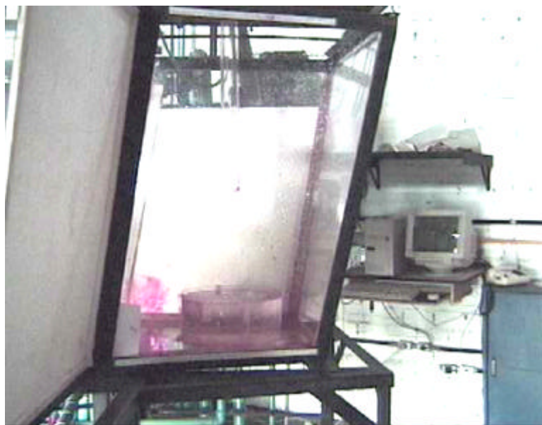
Figura 5.4. Entrada do distribuidor de lingotamento contínuo.
