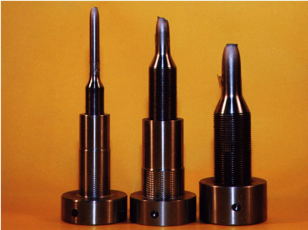
Figura 4-17 Corpos de prova de 10, 15 e 20 mm de diâmetro e peças para fixar empregadas na prensa 4
