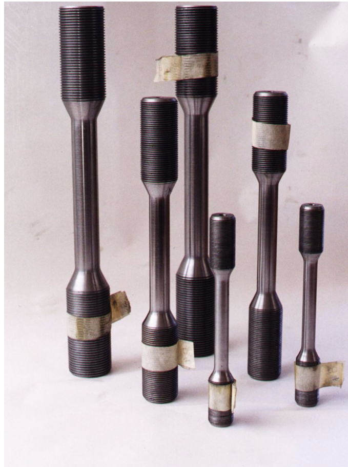
Figura 4-13 Corpos de prova de 10, 15 e 20mm de diâmetro
