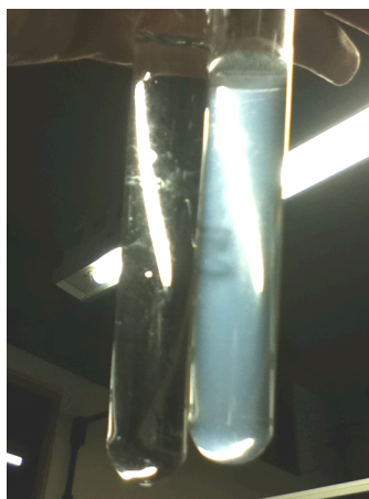
Figura 20. Comparação entre água pura (esquerda) e uma suspensão de nanopartículas em água formada a partir da solução AceB, a solução AceB-n.
