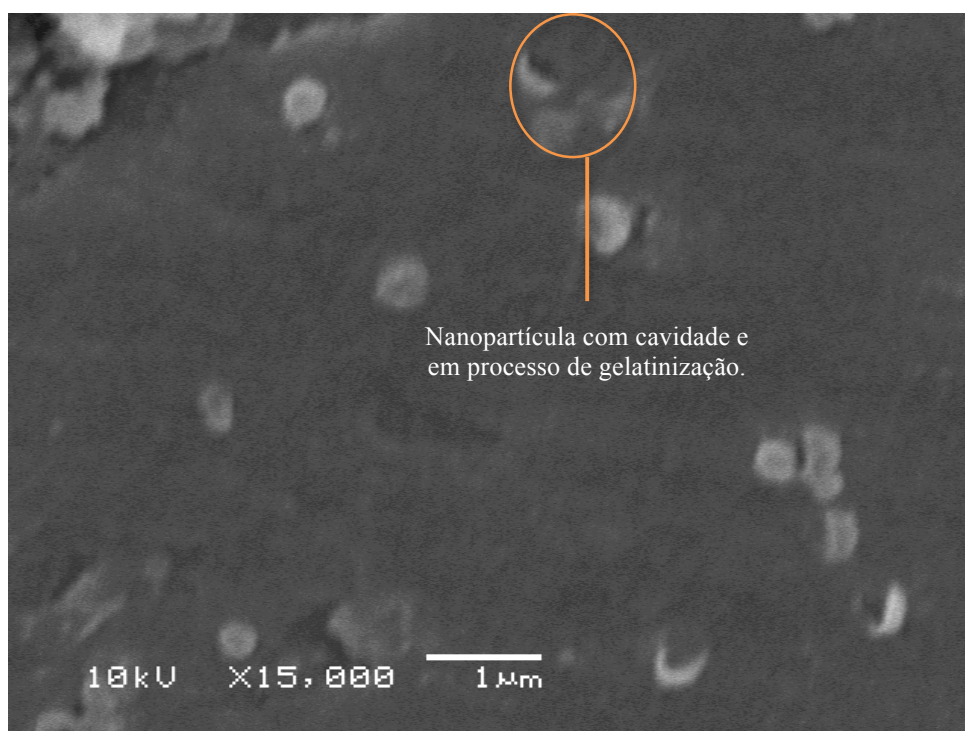
Figura 31. Imagem obtida por microscopia eletrônica de varredura das nanopartículas de pAmyl-D preparadas a partir da solução AceB.
