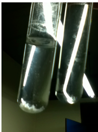
Figura 21. Comparação entre água pura (direita) e a solução IsoB-n (esquerda) no qual nota-se o precipitado aglomerado de pAmyl-D ao fundo do tubo de ensaio.
