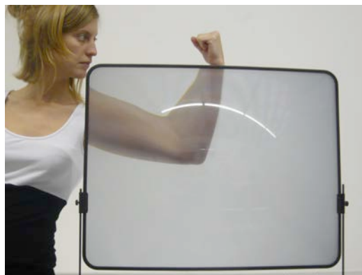
Figura 46 – Aplicação de lente Fresnel como lente de aumento
