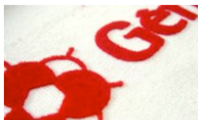
Figura 40 – Aplicação de flocagem em tecido
