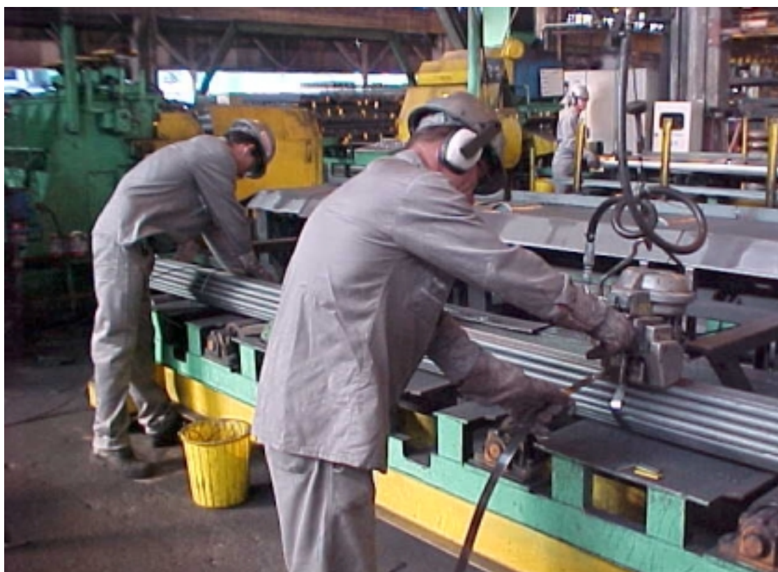
Foto 4 Área de Acabamento da Laminação onde as barras são cintadas e enviadas ao estoque.
