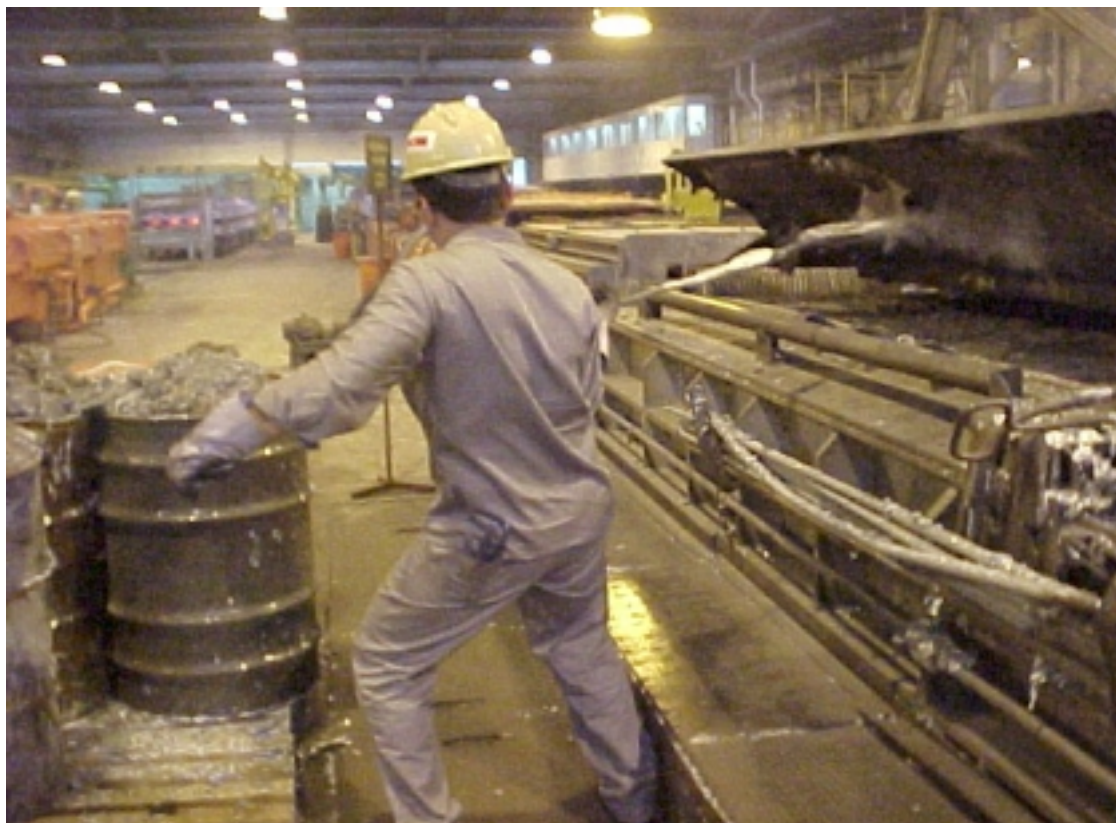
Foto 3 Área de Zincagem da Trefila - onde o arame recebe o banho de zinco.
