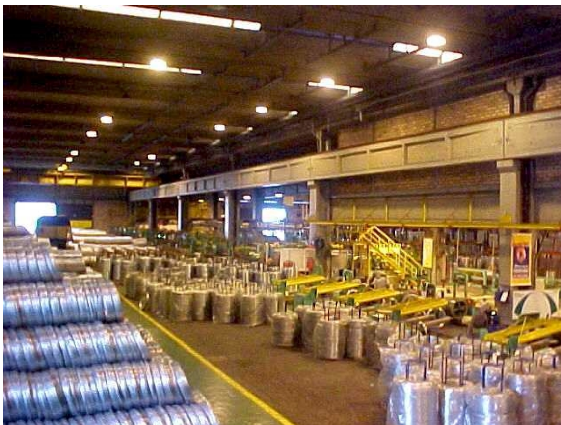
Foto 2 Área de Trefila - onde são produzidos arames ovalados para pecuária.
