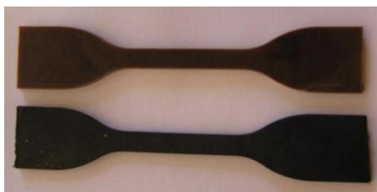
Figura 10 – Formato do corpo-de-prova tipo C segundo ASTM D 412.
