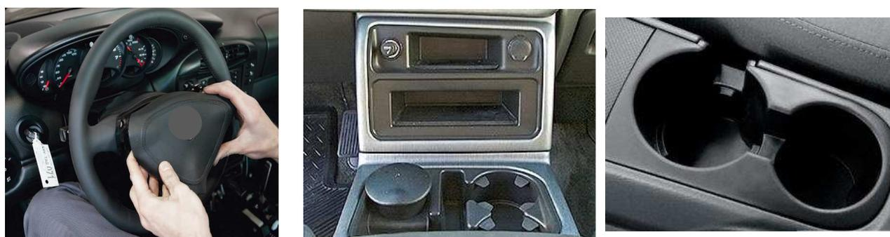
**Figura 3.** Direção e painel de um carro com peças em material *soft touch*
