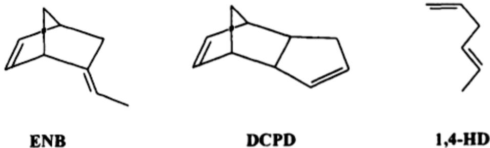
**Figura 10.** Dienos comerciais utilizados na copolimerização de diferentes EPDM's
