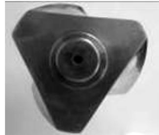
**Figura 33.** Rotores tipo roller utilizados para a elaboração das misturas
