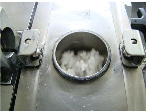
**Figura 34.** Início da mistura (fusão do polipropileno)
