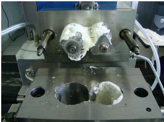
**Figura 36.** Câmara de mistura aberta para extração da mistura
