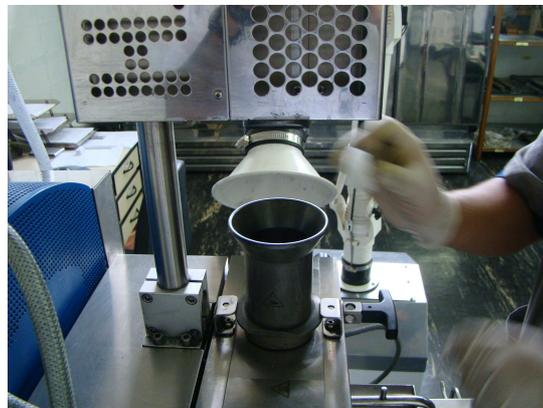
**Figura 35.** Introdução da borracha de EPDM na câmara de mistura
