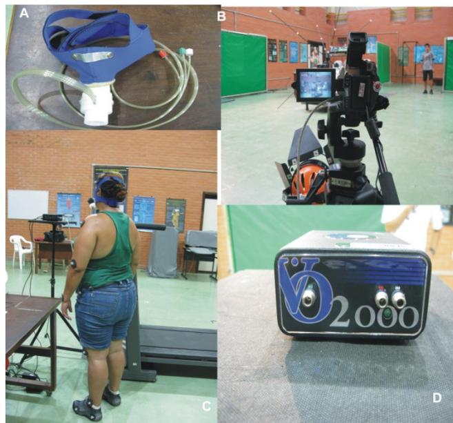
**Figura 5** Protocolo experimental (A) Máscara de neoprene acoplada ao pneumotacógrafo externo; conectada ao (D) sistema de medida metabólica (VO2000) via linhas de ar. (B) Disposição de uma das câmeras de video e (C) posição dos marcadores reflexivos.
