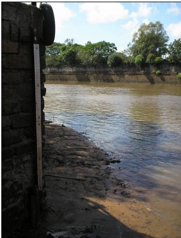
Figura 4: Régua linimétrica com cota fluiométrica máxima de 4 metros.
