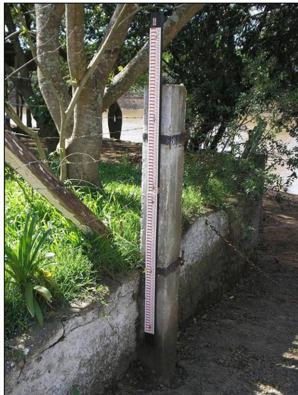
Figura 5: Régua linimétrica com cota fluiométrica máxima de 6 metros.
