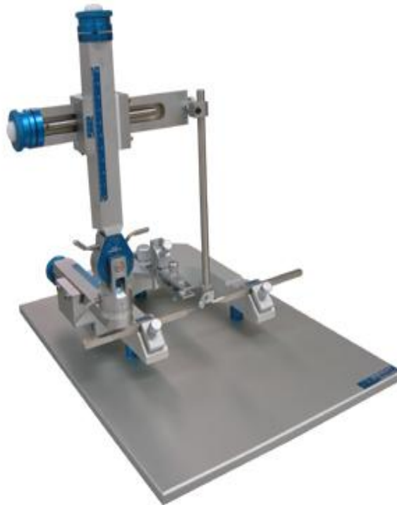
Fig.6. Aparelho para cirurgia estereotáxica
