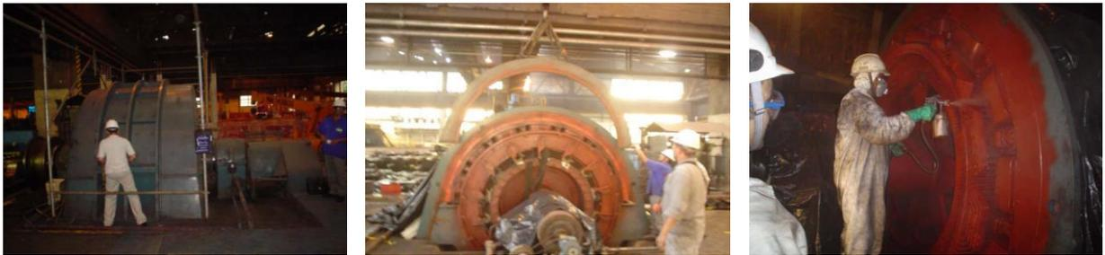
**Figura 29** À esquerda, máquina montada antes do início da manutenção. Ao centro, retirada da carenagem. À direita, impregnação com verniz isolante.
