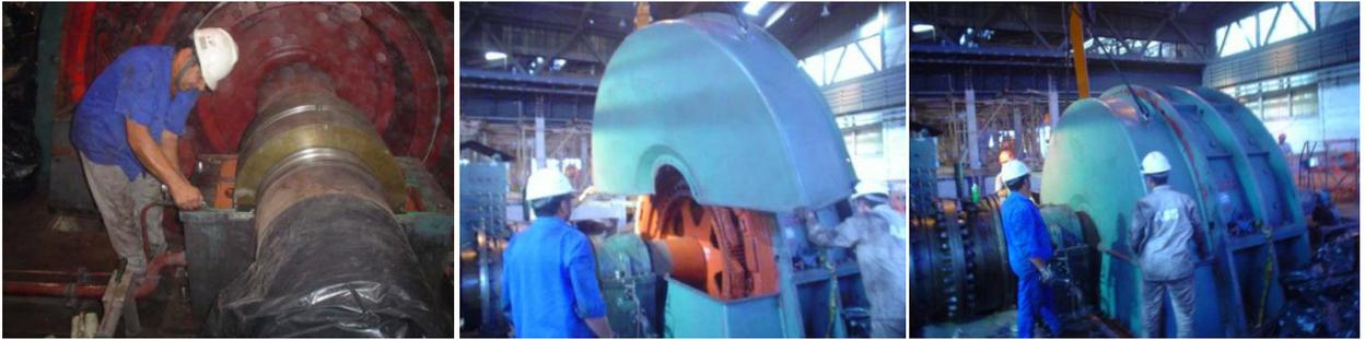
**Figura 31** À esquerda, selagem das caixas dos mancais. Ao centro, fechamento das carenagens. À direita, montagem das carenagens.
