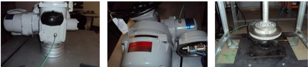
**Figura 41** Posições dos acelerômetros. a) caixa de engrenagem; b) compartimento do motor elétrico; c) freio a disco.
