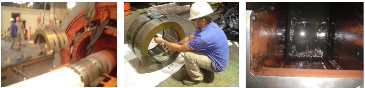
**Figura 30** À esquerda, retirada da bucha. Ao centro, controle micrometrado das buchas. À direita, condição de óleo após a retirada das buchas.
