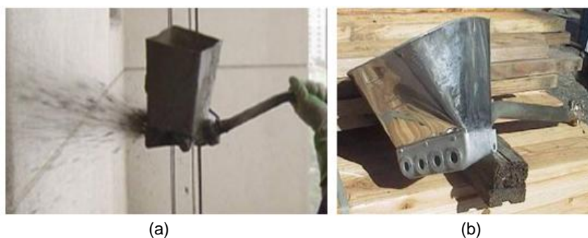
Figura 11: Projetor com recipiente acoplado (canequinha): (a) vista da expulsão mistura e (b) vista frontal
