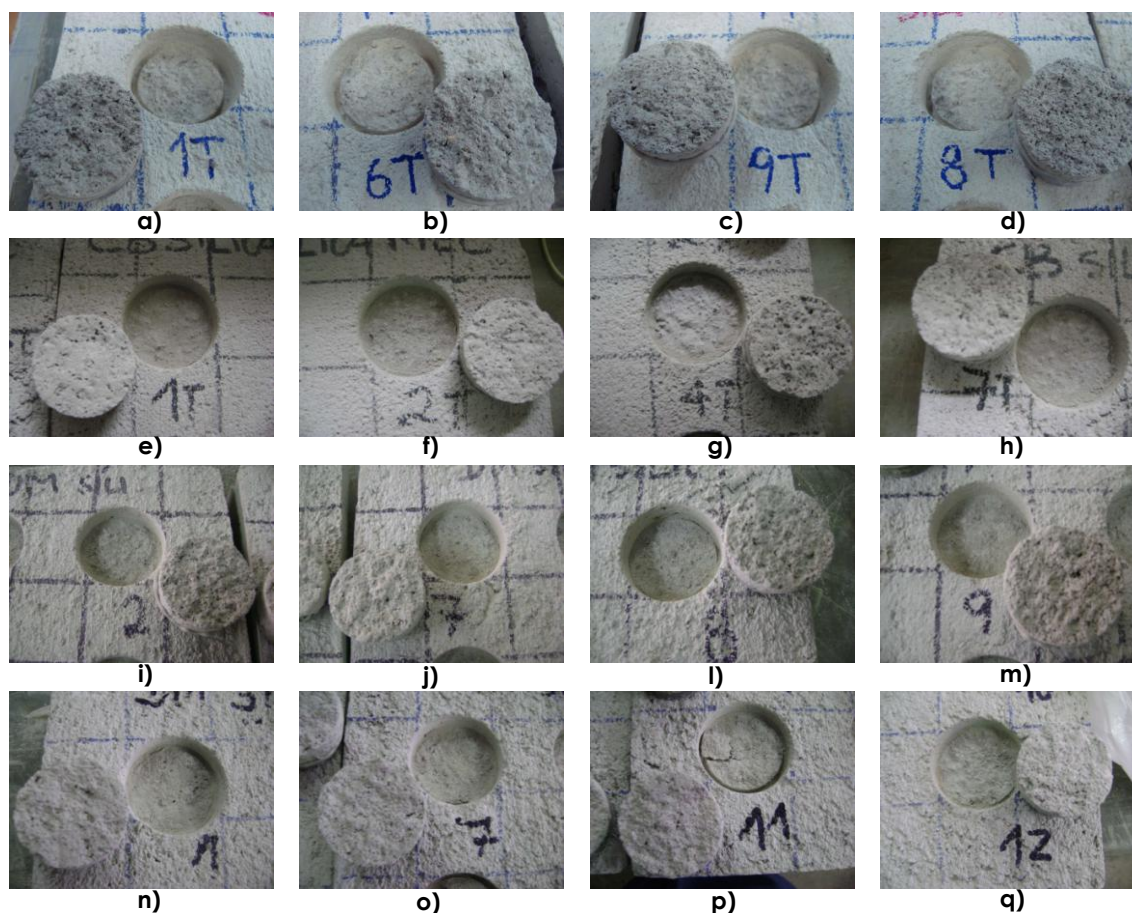
Figura 50: Corpos-de-prova submetidos ao ensaio de resistência de aderência à tração aos 28 dias: (a à d) CB manual com sílica; (e à h) CB mecanizado com sílica; (i à m) DM manual com sílica e (n à q) DM mecanizado com sílica
