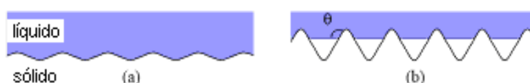
Figura 8: (a) Líquido em contato total com a superfície; (b) Líquido com falhas no contato com a superfície (Fonte: Pretto, 2007)
