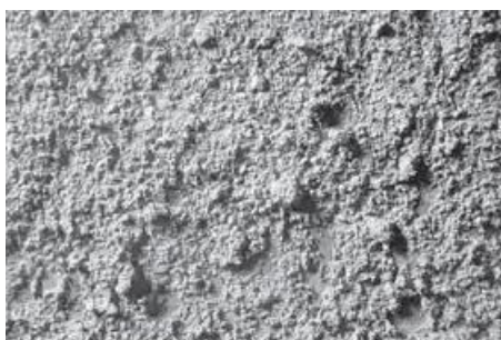
Figura 2: Aspecto do chapisco convencional (Fonte: Ceotto; Banduk; Nakakura, 2005)
