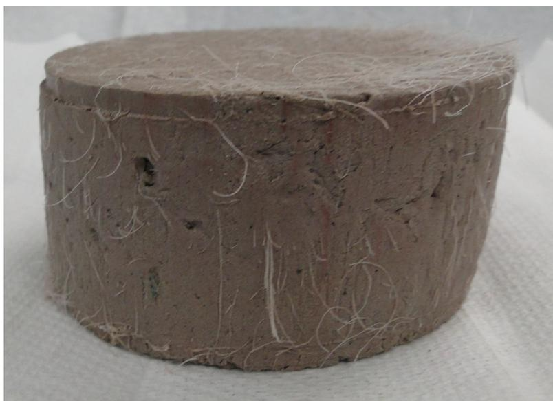
Figura 4.57: Amostra de resíduo de mineração cimentado reforçado com fibras após cisalhamento sob condições monotônicas ( $\sigma'_{v \text{ inicial}}=100\text{kPa}$ ).
