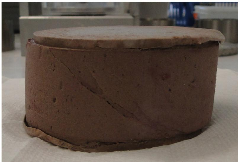
Figura 4.58: Amostra de resíduo de mineração cimentado não reforçado após cisalhamento sob condições cíclicas ( $\sigma'_{v \text{ inicial}}=50\text{kPa}$ ,  $\gamma=\pm 2,5\%$ ).
