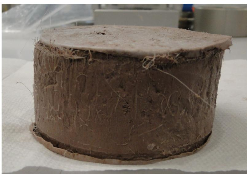
Figura 4.59: Amostra de resíduo de mineração cimentado reforçado com fibras após cisalhamento sob condições cíclicas ( $\sigma'_{v \text{ inicial}}=50\text{kPa}$ ,  $\gamma=\pm 2,5\%$ ).
