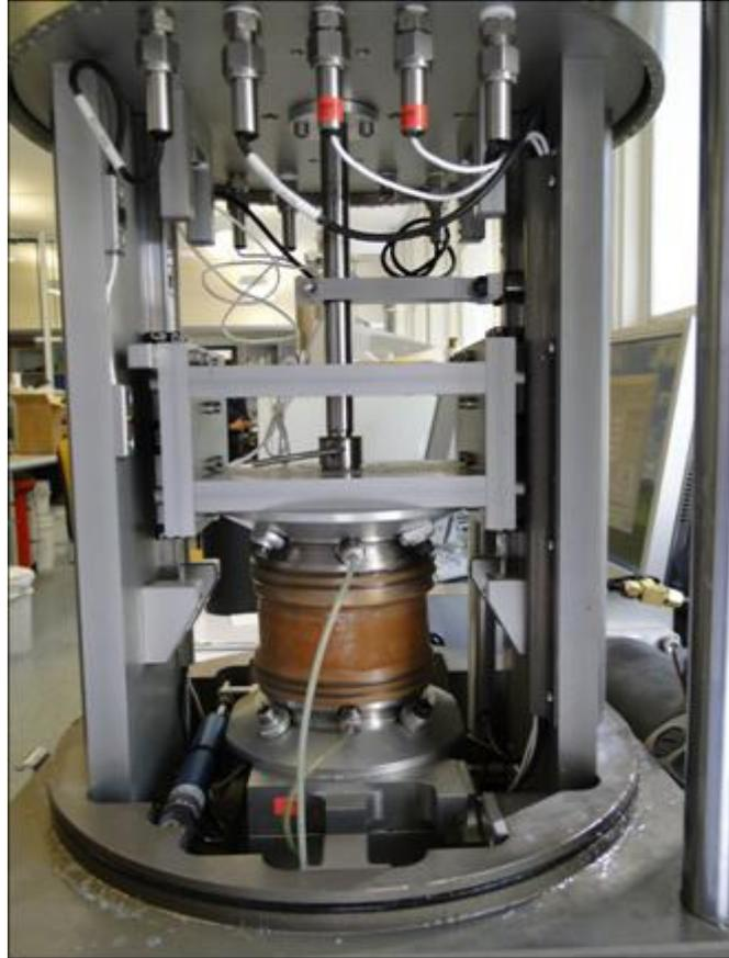
Figura 3.7: Amostra devidamente posicionada no equipamento *simple shear*.
