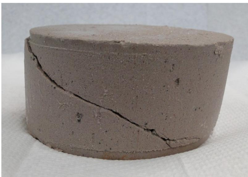
Figura 4.56: Amostra de resíduo de mineração cimentado não reforçado após cisalhamento sob condições monotônicas ( $\sigma'_{v \text{ inicial}}=100\text{kPa}$ ).
