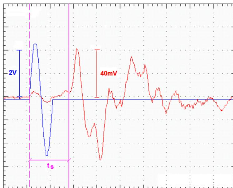
Figura 2.18: Determinação do tempo de propagação de uma onda S, pelo método da primeira chegada do sinal de resposta
