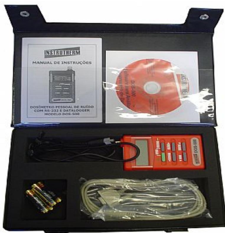
Figura 13 – Modelo utilizado nas medições de ruído e dose: dosímetro DOS 500.
