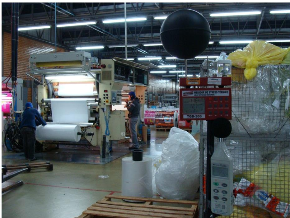
Figura 15 – Medidor de estresse térmico modelo TGD 300, utilizado na pesquisa.
