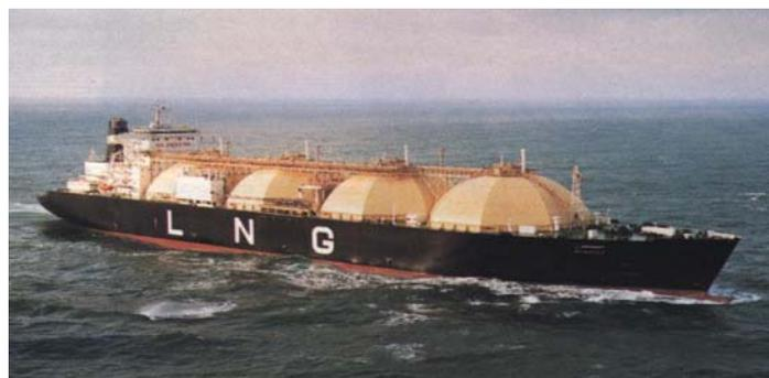
**Figura 3 - Navio criogênico usado para o transporte de GNL.**
