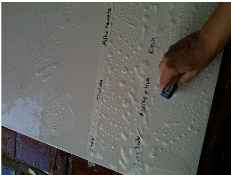
Figura 16: procedimento de limpeza com agente de limpeza fraco e escova
