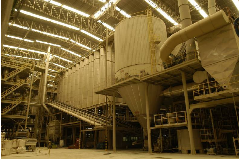
Figura 2: pó atomizado separado em silos (PORTOBELLO SA, 2010)
