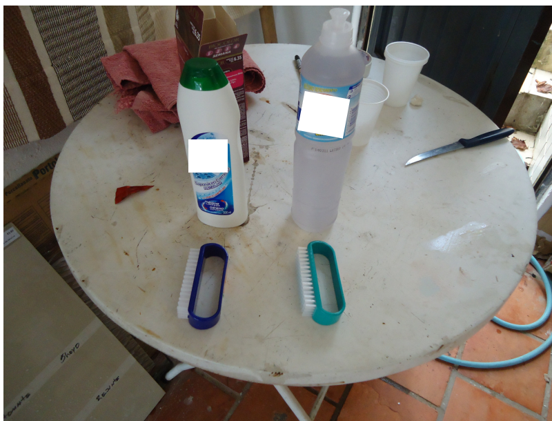
Figura 12: agentes de limpeza utilizados na determinação da resistência a manchas
