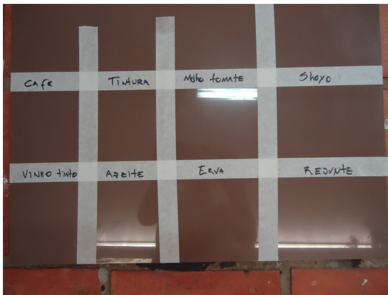
Figura 13: demarcação das placas em oito espaços e identificação dos agentes manchantes
