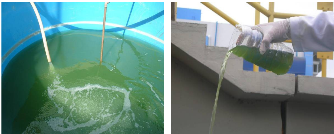
Figura 4.19: A esquerda-chegada da água do lago no reservatório de 10m 3 de água bruta. À direita-mistura das algas coletadas na lagoa de estabilização com a água do lago.
