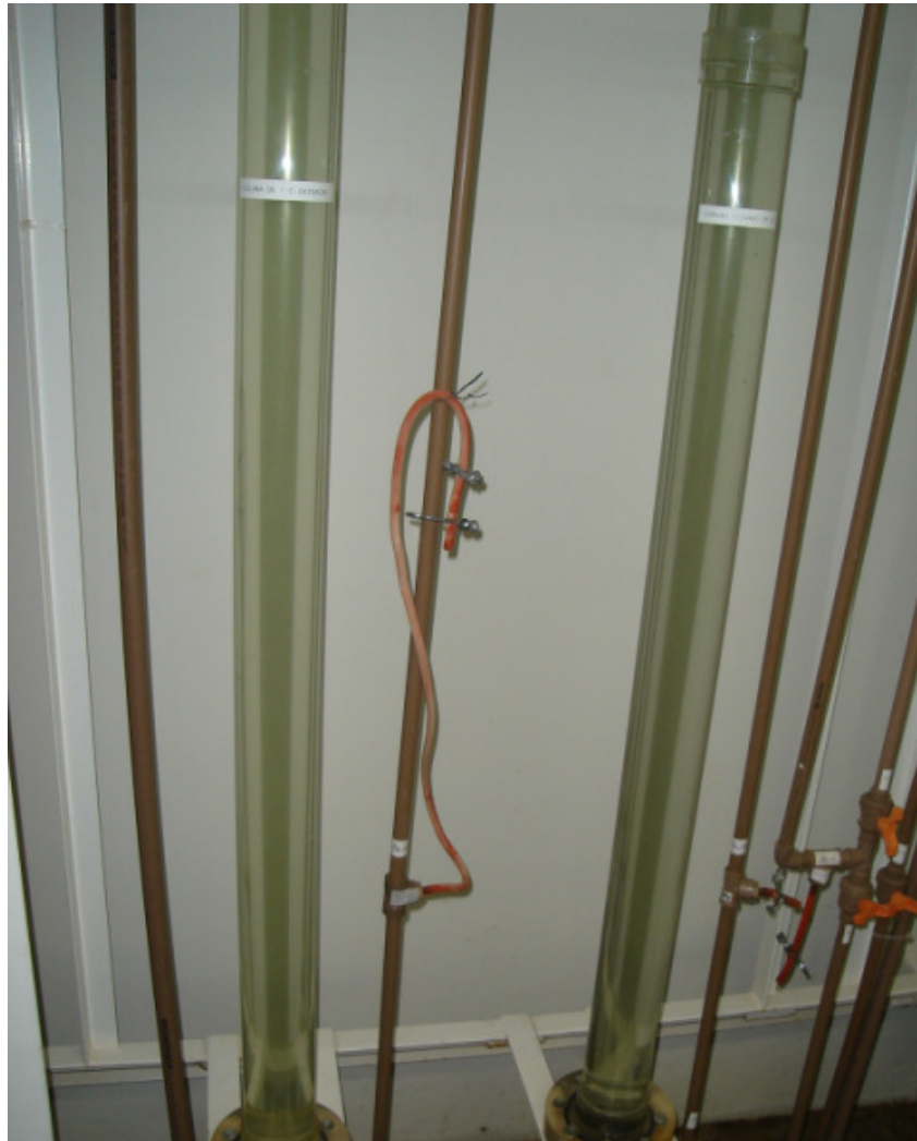
Figura 4.6: Colunas de pré-oxidação e adsorção em CAP.
