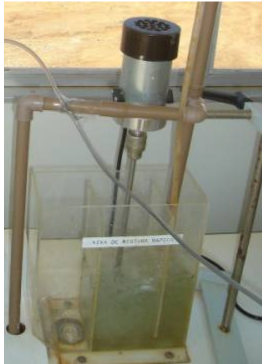
Figura 4.7: Detalhe da caixa de mistura rápida
