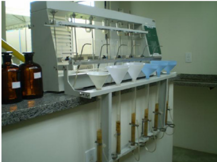
Figura 4.14: Aparelho de Jarreste com os filtros de laboratório de areia - FLA.
