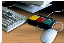
Figura 4- Mouse ++: subst. funções (três teclas): clique, clique duplo e arrastar.
