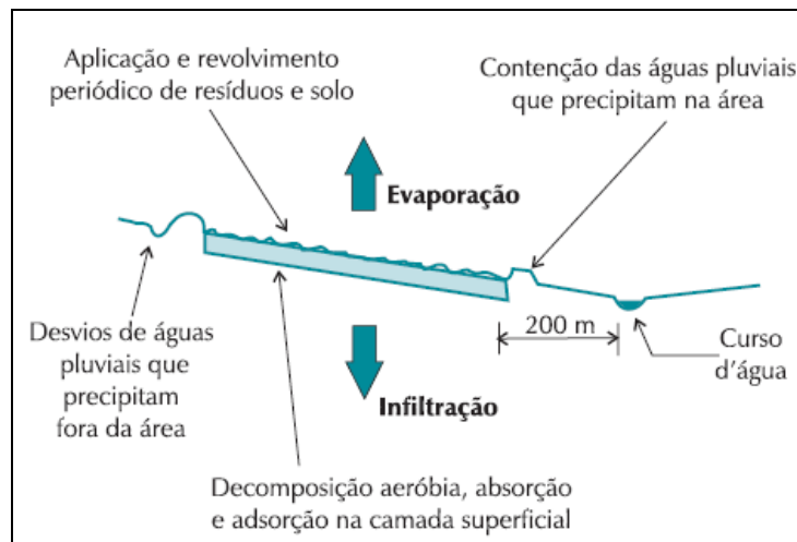
Figura 9. Seção esquemática de uma área de landfarming . Fonte: MONTEIRO et al (2001)
