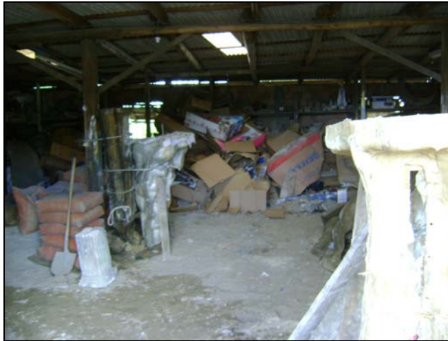
Figura 49. Resíduos de vários tipos (papel, papelão, sacos de argamassa, latas de tinta etc.) misturados, estocados temporariamente na empresa.
