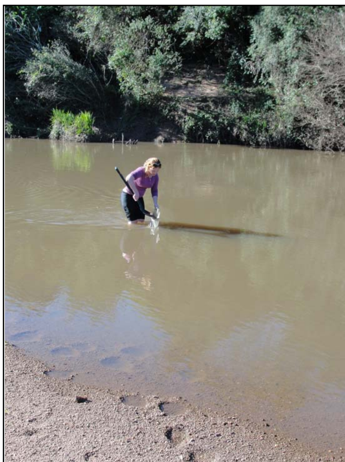
Fig. 10: Coleta realizada no canal do rio, com o auxílio de uma pá (ponto 11)
