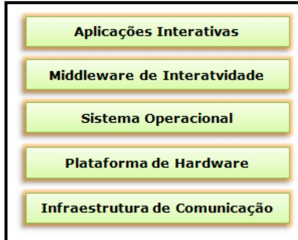
Figura 4.3 Estrutura em camadas de um receptor de TV Digital (BARBOSA & SOARES, 2008).
