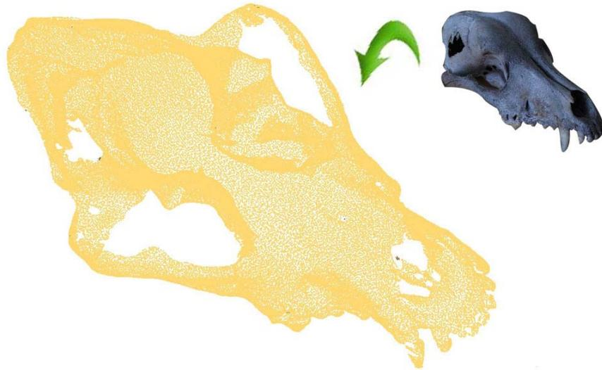
Figura 4: Exemplo de uma nuvem de pontos. No canto superior direito o objeto real digitalizado para obtenção da nuvem.
