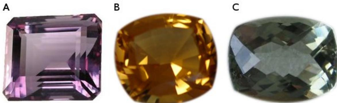
Figura 10: Exemplo de ametista natural (A), citrino tratado termicamente (B) e prasiolita tratada através de radiação (C).
