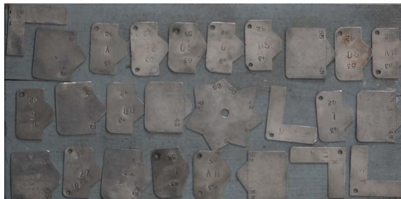
Figura 17: Gabaritos com diferentes ângulos usados na etapa de pré-formação da gema.
