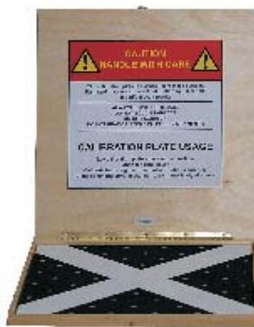
Figura 25: Placa de calibração do digitalizador.
