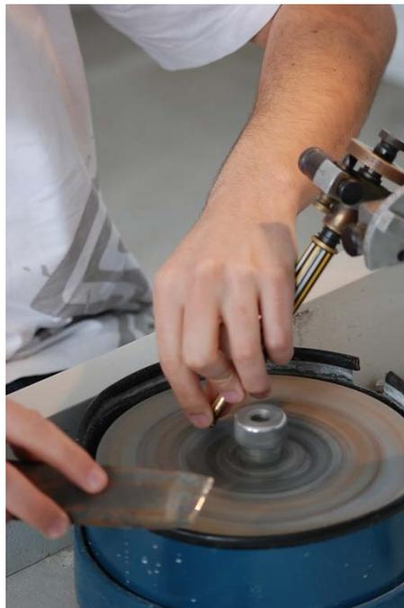
Figura 20: Equipamento de processo mecânico de lapidação.
