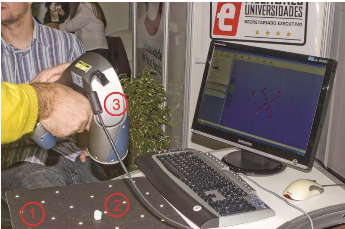
Figura 31: Digitalização de uma gema, onde (1) é a plataforma com as etiquetas reflexivas para orientação do equipamento, (2) é a amostra de gema martelada que esta sendo digitalizada e (3) é o equipamento digitalizador portátil a laser.
