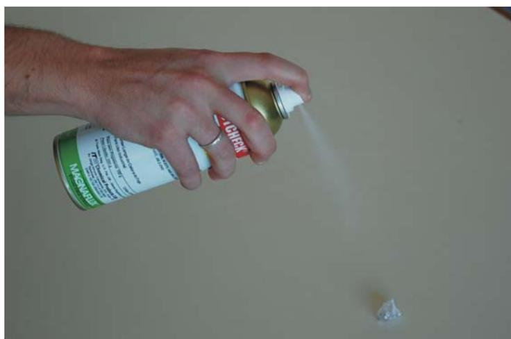
Figura 28: Pó revelador sendo aplicado em uma amostra de quartzo.
