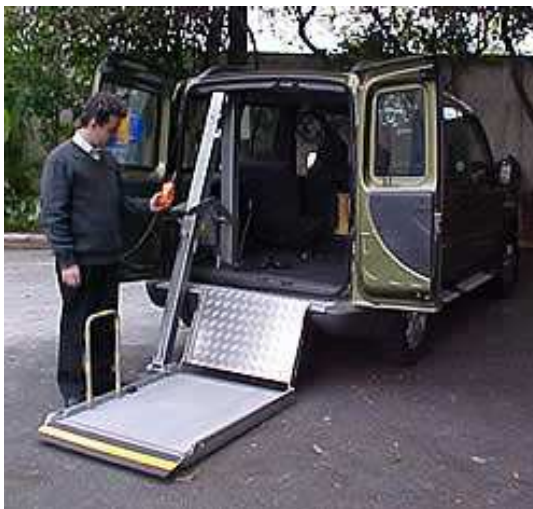
Figura 25 19 - Carro equipado com elevador.
