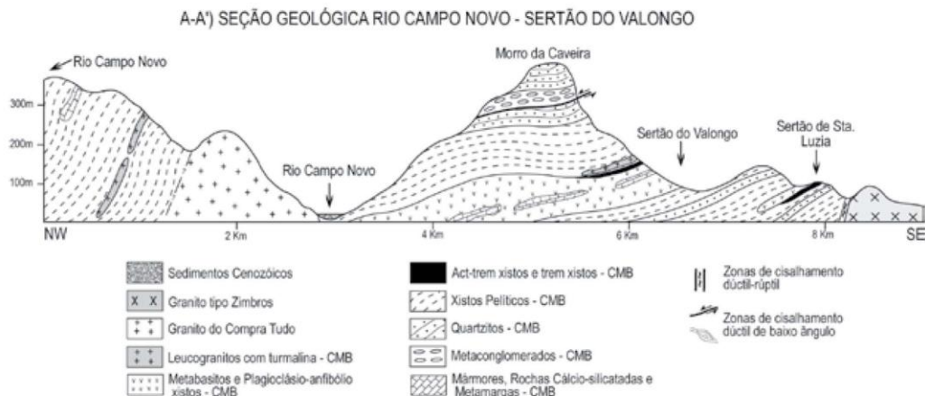
Figura 4 - Seção geológica esquemática Rio Campo Novo-Sertão do Valongo, mostrando a disposição espacial e os principais elementos estruturais das unidades do Complexo Metamórfico Brusque (modificado de Philipp et al. 2004).
