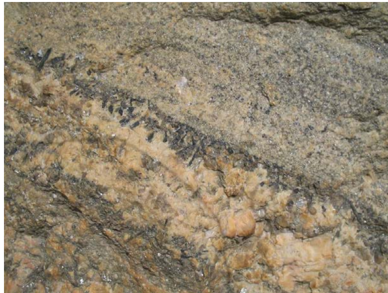
Figura 53 – Detalhe do bandamento magmático caracterizado pela diferença de tamanho de grão e composição mineralógica. BR-101, Itapema.
