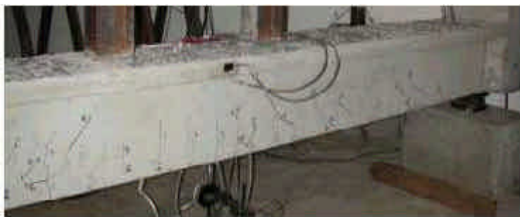
Figura 8.26–Fissuração na VFC-3 após a protensão 1 ( F_v=31,9 kN)
