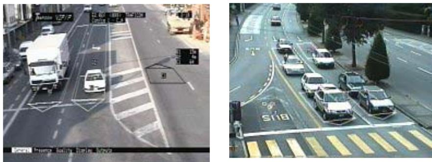
**Figura 9:** Exemplo de detetor veicular por imagem. Fonte: (Traficon, 2000).
