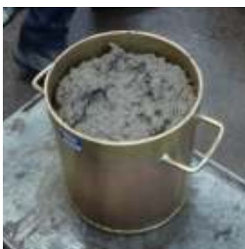
Figura 16: cilindro metálico de 250 mm de diâmetro e 280 mm de altura
