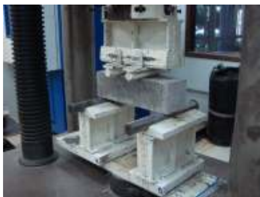
Figura 18: ensaio de resistência à tração na flexão
