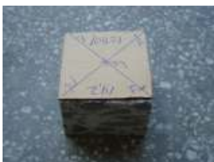
Figura 27: amostra para execução do ensaio de resistência à abrasão
