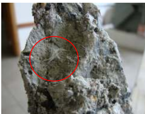
Figura 34: presença de grumos de microfibras de PP em corpo-de-prova submetido ao ensaio de resistência à compressão (SENISSE, 2010)
