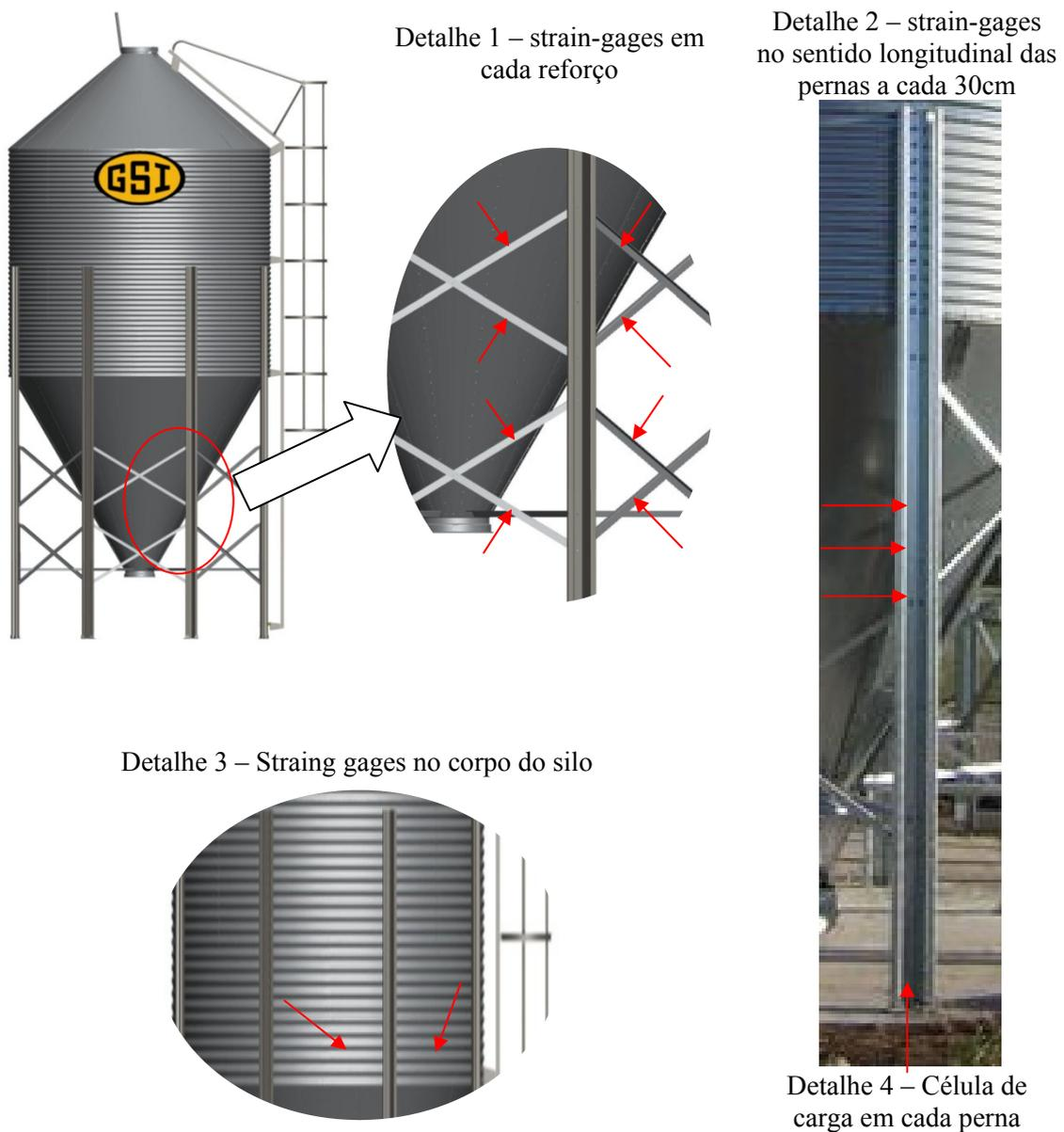
**Figura D.2: Silo 2 com as identificações dos pontos de medição**
