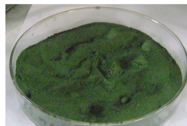
Figura 1. Cinzas de resíduos da indústria calçadista utilizadas neste trabalho.
