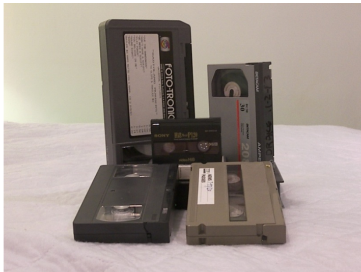
Figura 29 – Todos os suportes magnéticos e digitais Da esquerda para a direita: ao fundo, U-Matic; ao centro, DCV-Pró; abaixo, S-VHS; à direita, Betacam e à frente, S-VHS digital. Fonte: Arquivo de fitas TVE.
