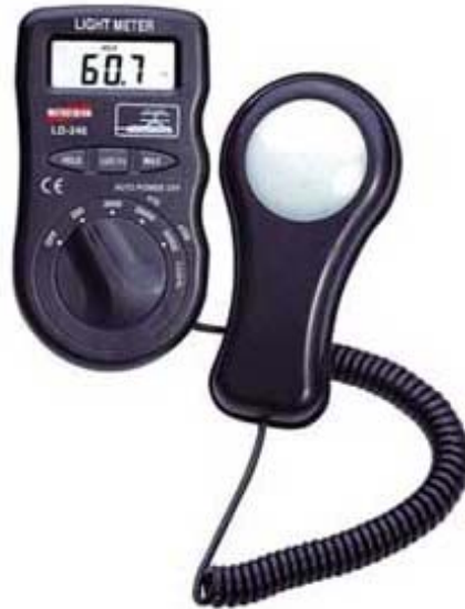
Figura 37 - Luxímetro digital modelo LD 240 Fonte: Imagem do autor
