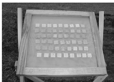
Figura 4 - Exposição dos corpos-de-prova ao intemperismo
