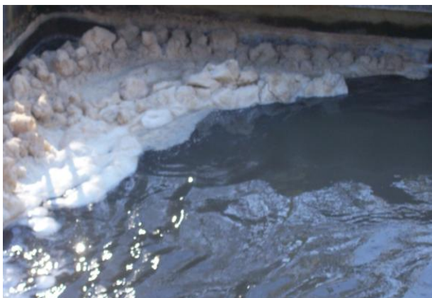
Figura 12 – Flocos formados após a adição de cal na água
