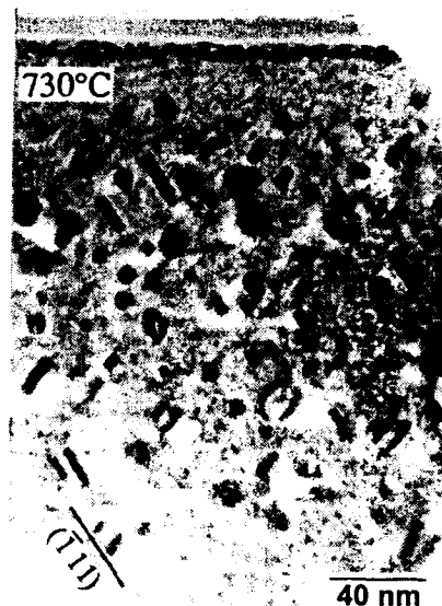
Figura 6.6: Micrografia TEM em vista transversal de uma amostra de Fe implantada com Si que foi recristalizado por IBIEC e ainda recozida em 730°C por 30 min.. Note que a camada superficial ( \sim 6\text{nm} de espessura) consiste de precipitados \beta\text{-FeSi}_2 . A região logo abaixo desta camada encontra-se rarefeita de precipitados. A região mais profunda é bastante ampla e apresenta precipitados \gamma\text{-FeSi}_2 e \beta\text{-FeSi}_2 .
