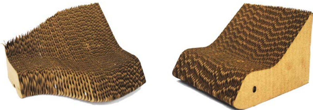
Figura 7.2: duas partes do banco montadas a partir das seções cortadas
