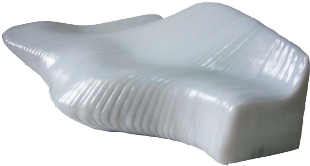
Figura 7.3: revestimento de modelo com termoplástico
