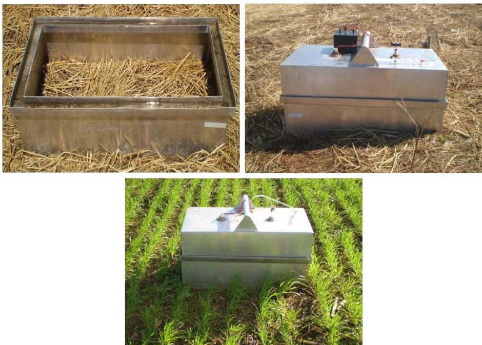
Figura 3. Vista geral da câmara estática (base e câmara) utilizada para coleta de gás.
