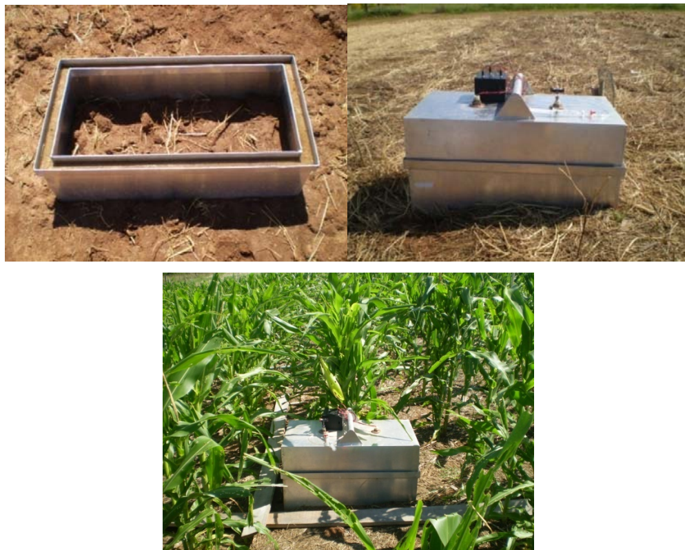
Figura 2. Câmara utilizada para coleta de gases.
