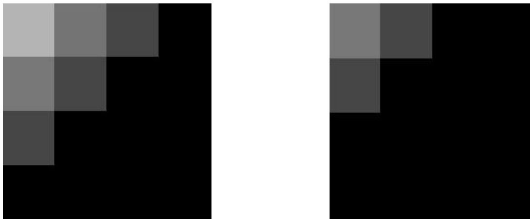
Figura 2.14: Bloco 4x4 ao sofrer processo de quantização: à esquerda o bloco após sofrer a transformada e à direita após a quantização.
