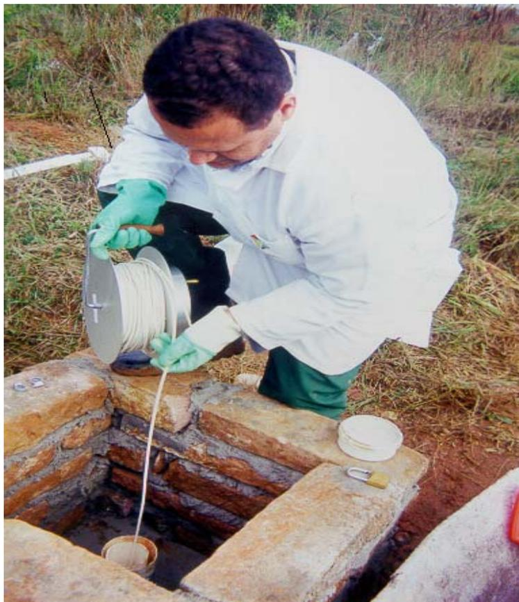
Figura 22: Medição do nível de água dos poços
