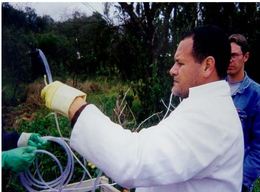
Figura 23: Conjunto (bomba, tubulação e fiação) utilizadas no esgotamento e amostragem
