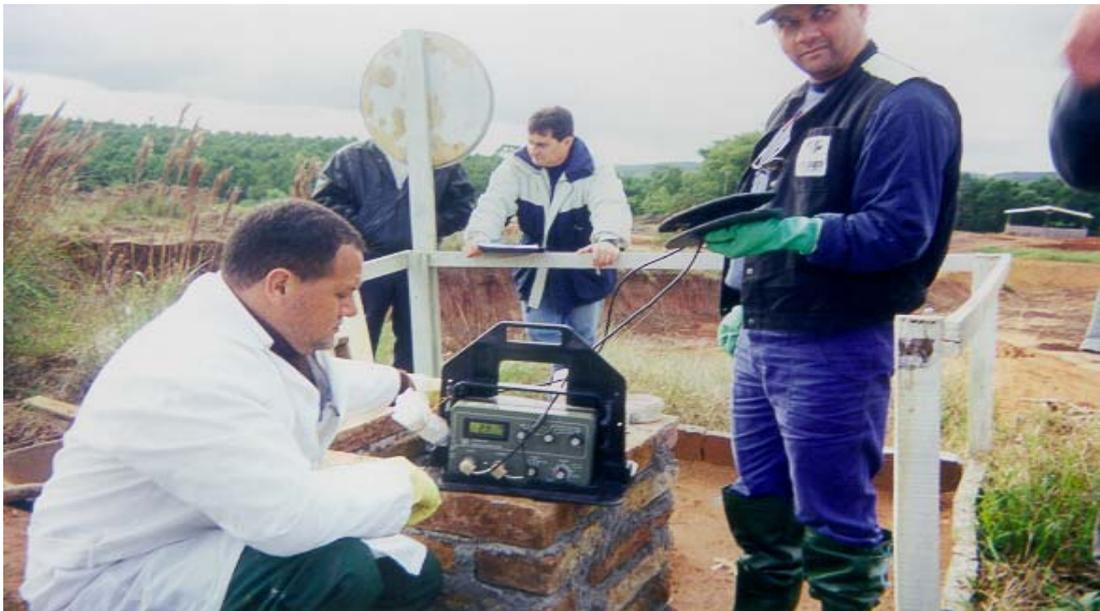
Figura 24: Equipamento de campo utilizado para medição de OD
