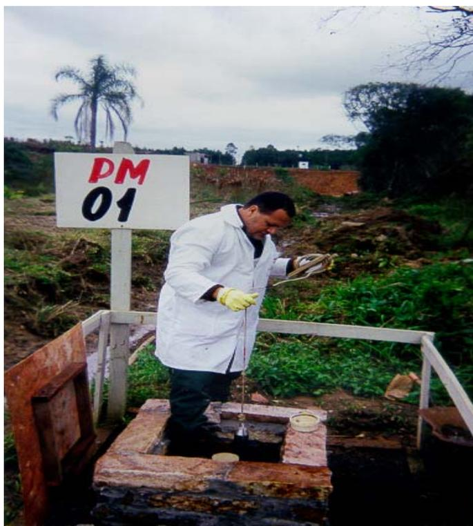
Figura 21: Medição da profundidade dos poços
