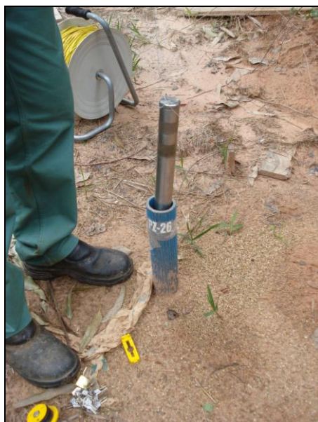
Figura 19 - Foto da coleta da amostra de água subterrânea no poço PZ 26. Amostra coletada entre 15 e 17 m de profundidade, conforme orientação do estudo geofísico.
