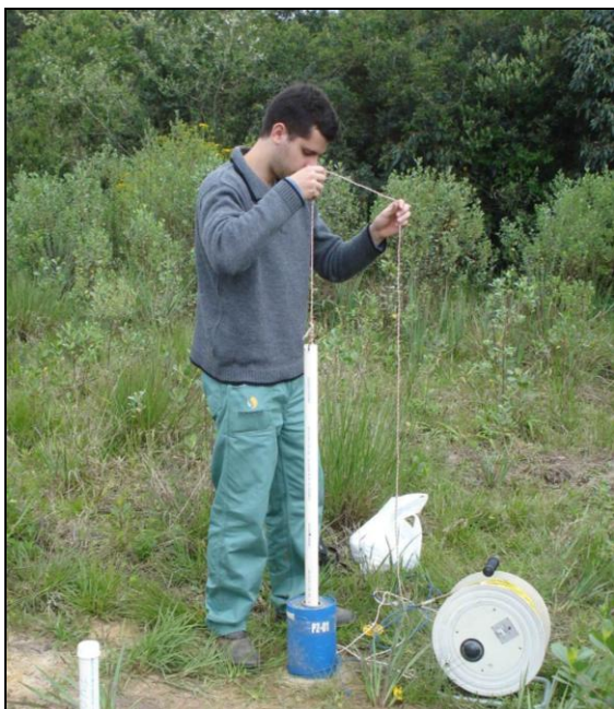
Figura 21 - Foto do Sólido de PVC branco utilizado nos ensaios de slug .
