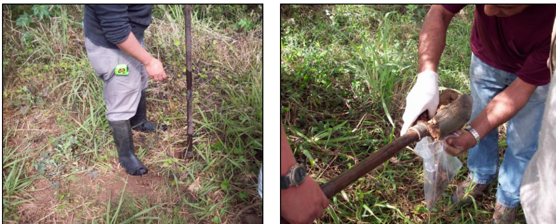
Figura 11 - Foto da execução da sondagem a trado e coleta de amostra de solo
