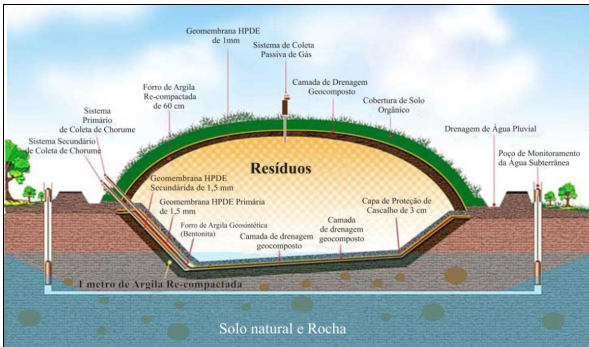
Figura 9 - Modelo de célula de disposição de resíduos sólidos industriais Classe I. Fonte: modificado de PPLi (2010).
