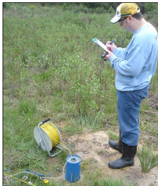
Figura 22 - Foto do Ensaio de slug : monitoramento do rebaixamento do NA com medidor de interface sonora marca Jaciri (cabo amarelo).
