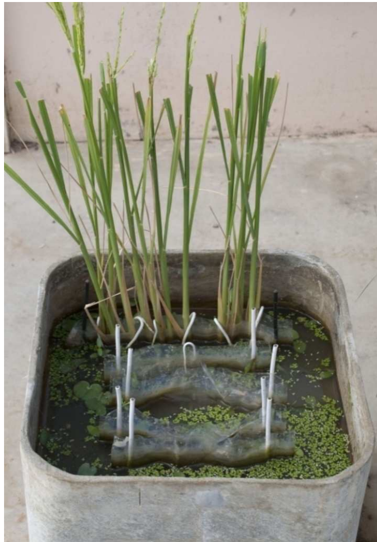
Figura 2 – Unidade experimental preenchida com um Gleissolo Háplico, contendo os sacos de vinil e as respectivas plantas de arroz com raízes removidas.
