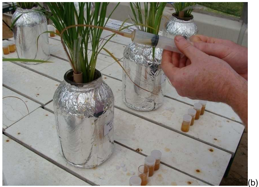
Figura 16 - Detalhes do mecanismo utilizado para coleta de solução do solo (a) e ilustração da coleta (b).
