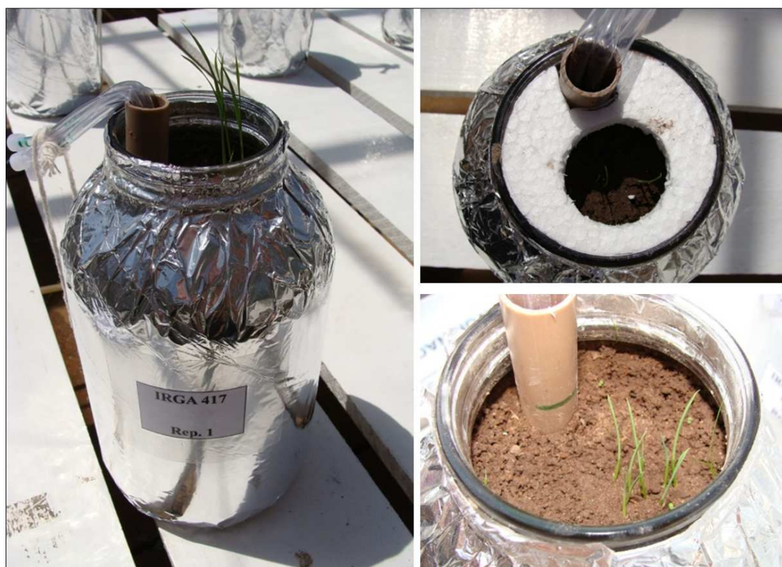
Figura 15 - Detalhes das unidades experimentais utilizadas para cultivo dos genótipos de arroz em solo alagado em casa de vegetação.
