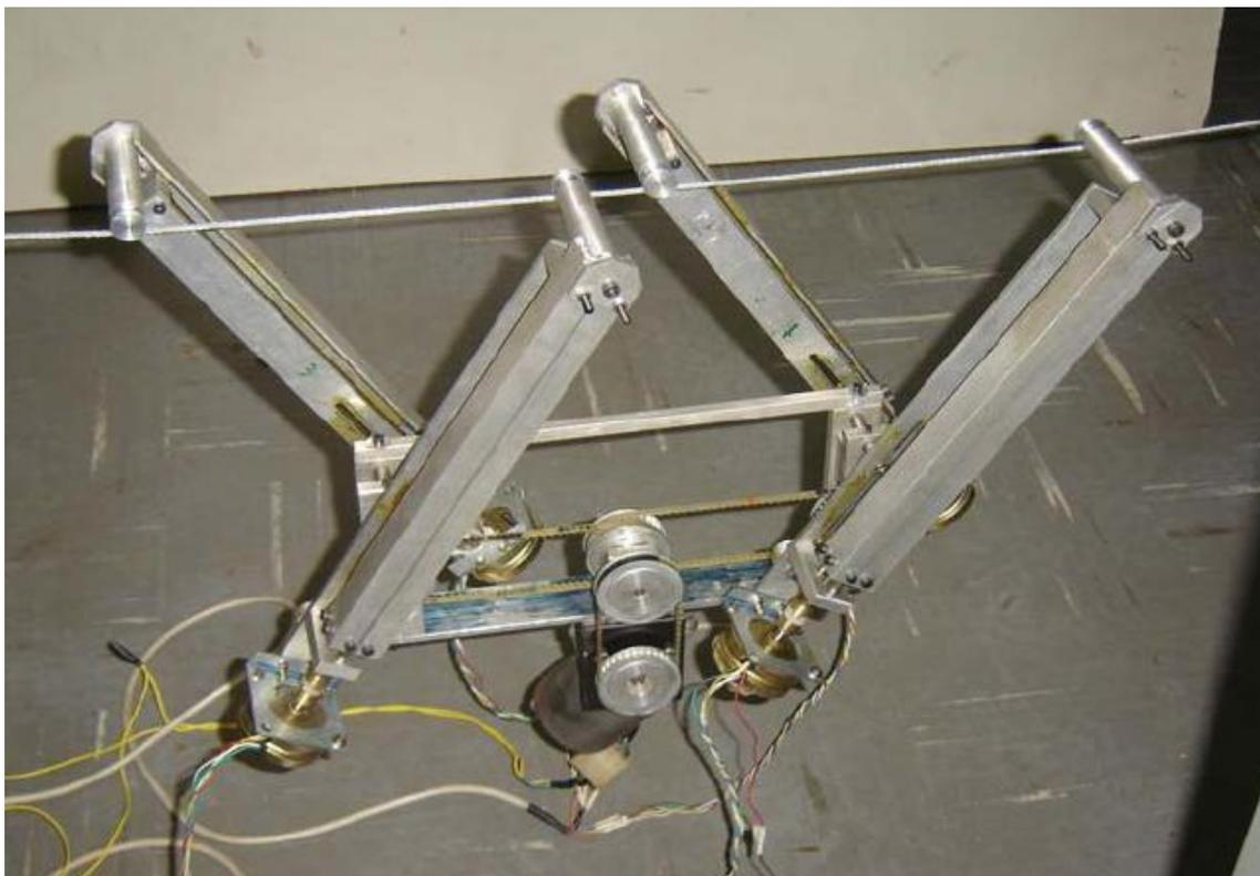
Figura 37: Configuração geral do robô suspenso por fio.
