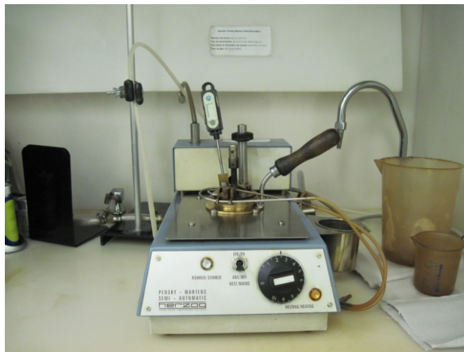
Fig. 2: Herzog Ponto de Fulgor Semi-Automático Pensky-Martens para determinação do ponto de fulgor.
