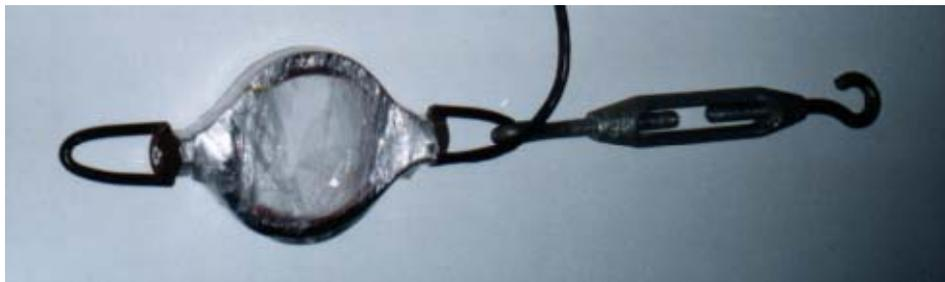
Figura 19: Anel de força, impermeabilizado com filme plástico para evitar contato com a água.
