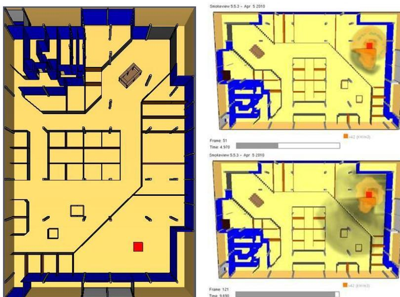
Figura 5.6: Representação da carga de incêndio através de um queimador tipo “vent”.
