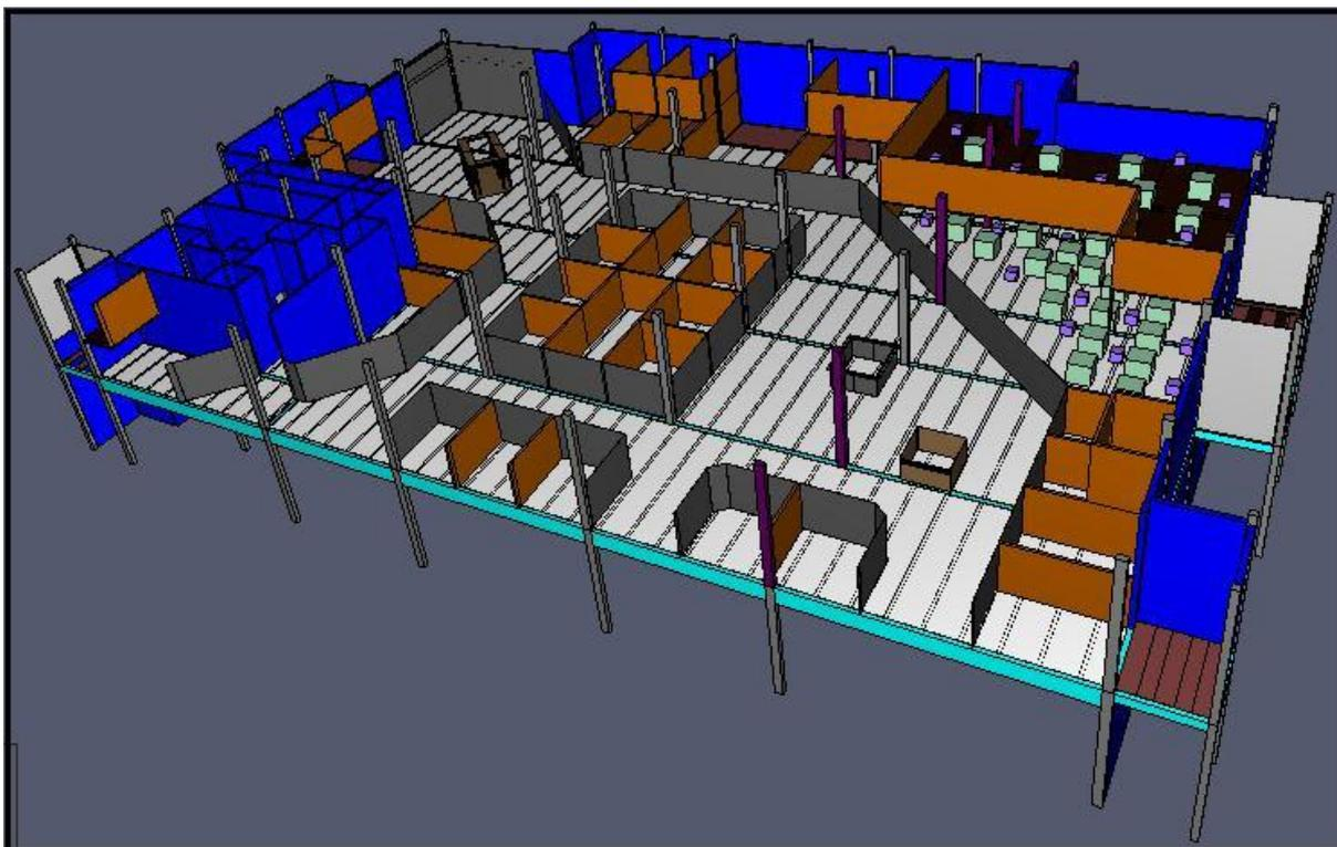
Figura 5.9: Vista interna do 2º pavimento do módulo E com a representação adotada para o material combustível no interior da loja (blocos de espuma em verde e de PVC em lilás).
